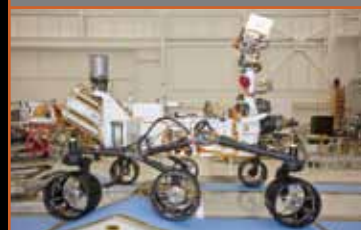
Исследовательский марсоход (Curiosity/Любопытство) тяжелого класса - мобильная долговременная автоматическая научная лаборатория. Аппарат должен будет за несколько месяцев пройти от 5 до 20 километров и провести полноценный анализ марсианских почв и компонентов атмосферы.
